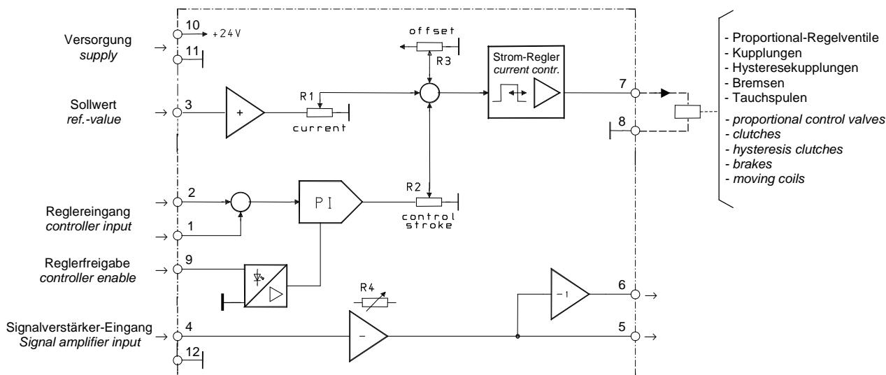
Wenn der PI-Regler benutzt wird kann der Eingang „Ref.-Value“ [3] bei Bedarf als Summiereingang verwendet werden. Er ermöglicht es das Stellglied mit einer Sollwertvorsteuerung zu betreiben. Da jetzt nur noch die Soll-/Istwert-Abweichung vom Regler korrigiert werden muss, werden Stabilität und Dynamik des Regelkreises erheblich verbessert.
