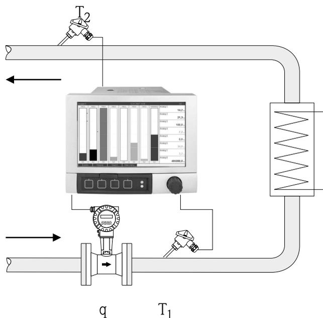
$$E = q \cdot \rho(T_1) \cdot c_m \cdot (T_2 - T_1)$$
