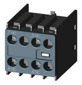
AUX.SWITCH BL 11U,1NO+1NC,FRONT CURR.PATH: 1NO, --, 1NC, --, F. CONT. RELAYS A. MOTOR CONT., SZ S00 AND S0, SCREW TERMINAL .7 / .8,-- / --,.5 / .6,-- / --
