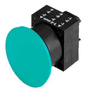
22MM PLASTIC ROUND ACTUATOR: PUSH-PULL BUTTON 40MM LATCHING W.PULL-TO-UNLOCK MECH. WITH HOLDER BLACK
