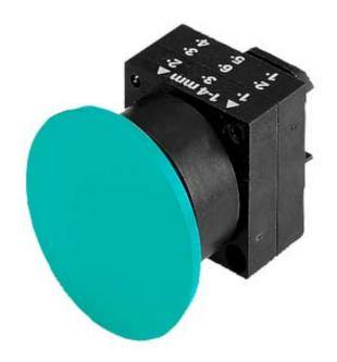
22MM PLASTIC ROUND ACTUATOR: PUSH-PULL BUTTON 40MM LATCHING W.PULL-TO-UNLOCK MECH. WITH HOLDER RED
