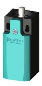
SIRIUS POSITION SWITCH; PLASTIC HOUSING ACC. TO EN50047, 31MM DEVICE CONNECTION 1X (M20X1.5); 1NO/2NC SNAP-ACTION CONTACTS TEFLON PLUNGER
