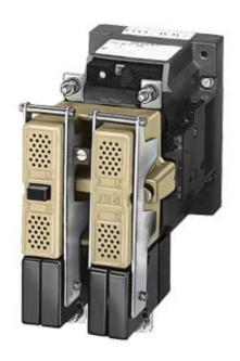
CONTACTOR, SIZE 4, 2-POLE DC-3 AND 5,RATD.OPERAT.CURR.75A AUXILIARY CONTACTS 22 (2NO+2NC) DC OPERATION DC 24V
