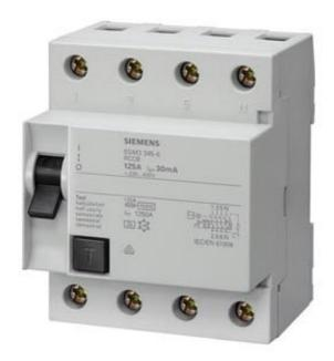
RES.CURRENT OP.CIRCUIT BREAKER TYPE A PSE/SSF 125A 3+N-POL IFN 500MA 400V 4MW FOR SELECTIVE SWITCH OFF
