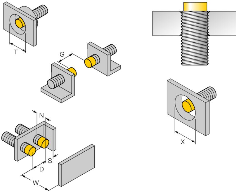
Todos los interruptores de tubo roscado *uprox*®, de montaje no enrasado, permiten el montaje hasta el borde del tubo. Por lo tanto la operación segura tiene una reducción máxima garantizada de la distancia de conmutación del 20 %.
