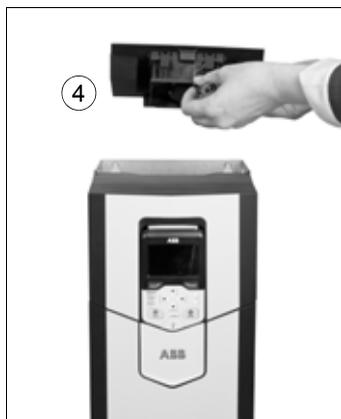
■ **Sustitución del ventilador de refrigeración auxiliar en los convertidores ACS880-01-xxxx-7 con bastidor R4 y R5 (IP 55 y opción +C135) y bastidor R5 IP 21**
