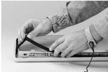
7. Levante la parte posterior del módulo de pantalla separándola del bisel.
