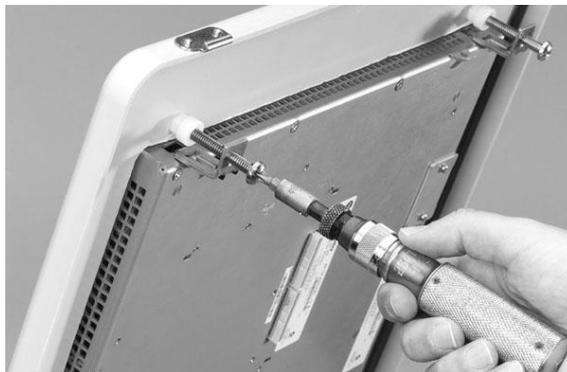
6. Apriete los tornillos de las abrazaderas de montaje a un par de 0.90...1.1 N•m (8...10 lb•pulg.) mediante la secuencia de par especificada; asegúrese de no apretar demasiado.
