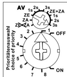
**Con el selector superior** se puede desconectar, este regulador en total o por partes del control centralizado:
