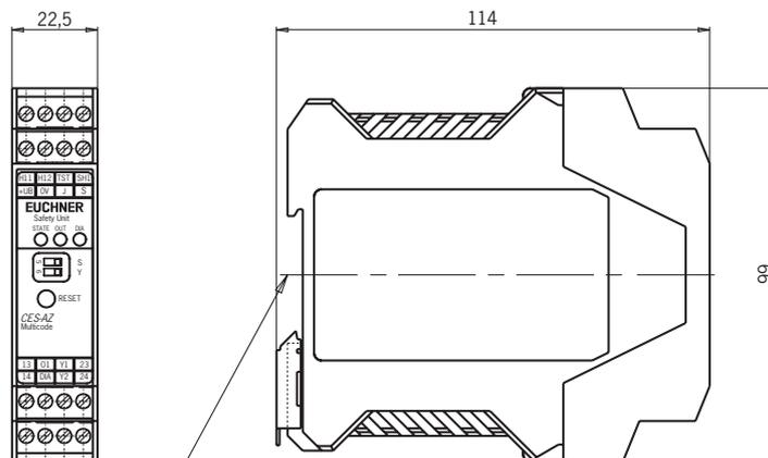
Compatible con riel de montaje DIN estándar de 35 mm
