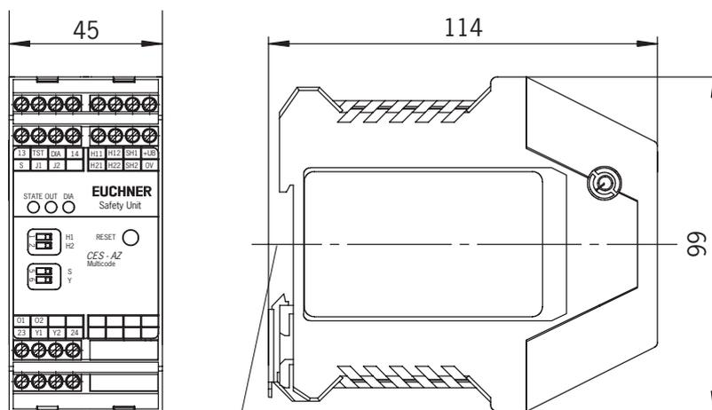
Compatible con raíl de montaje de 35 mm según EN 60715
