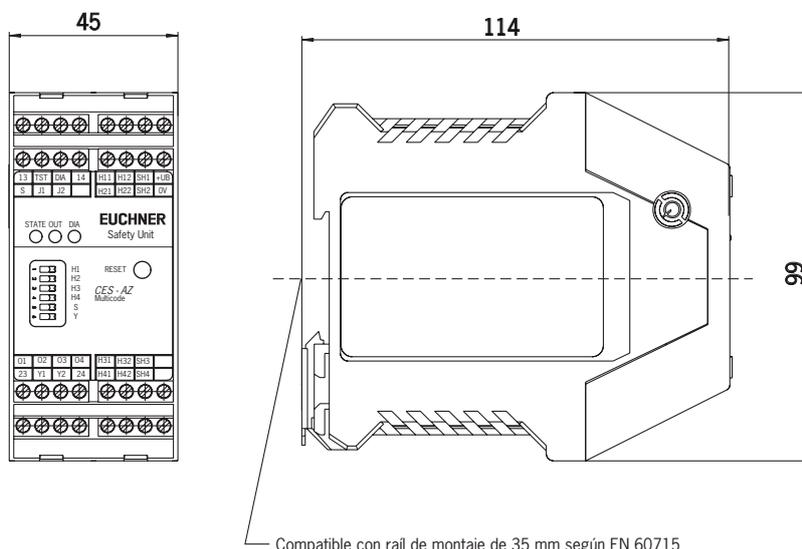
Compatible con raíl de montaje de 35 mm según EN 60715
