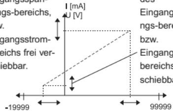
Anzeigewert innerhalb des Anzeigebereichs frei verschiebar
