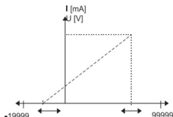
I valori visualizzati possono essere spostati liberamente all'interno del campo di visualizzazione
