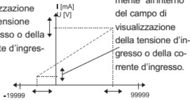
I valori visualizzati possono essere spostati liberamente all'interno del campo di visualizzazione
