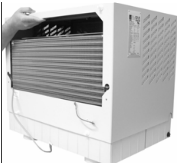
Imagen 27: Retirar la cubierta
