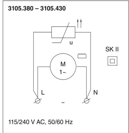
Imagen 6: Esquema de conexiones resistencia calefactora con ventilador
