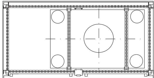
Imagen 7: Refuerzo del techo en el armario TS 8
