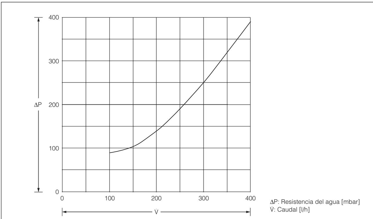
Imagen 36: Resistencia del agua SK 3210.xx4
