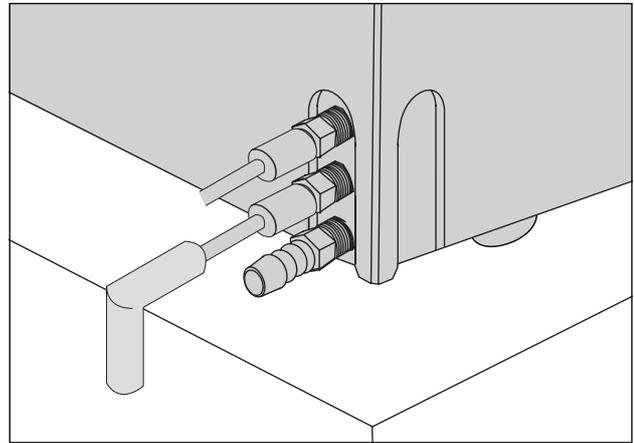
Imagen 10: Conectar en la parte lateral del aparato la entrada (arriba) y la evacuación (centro) del agua de refrigeración
