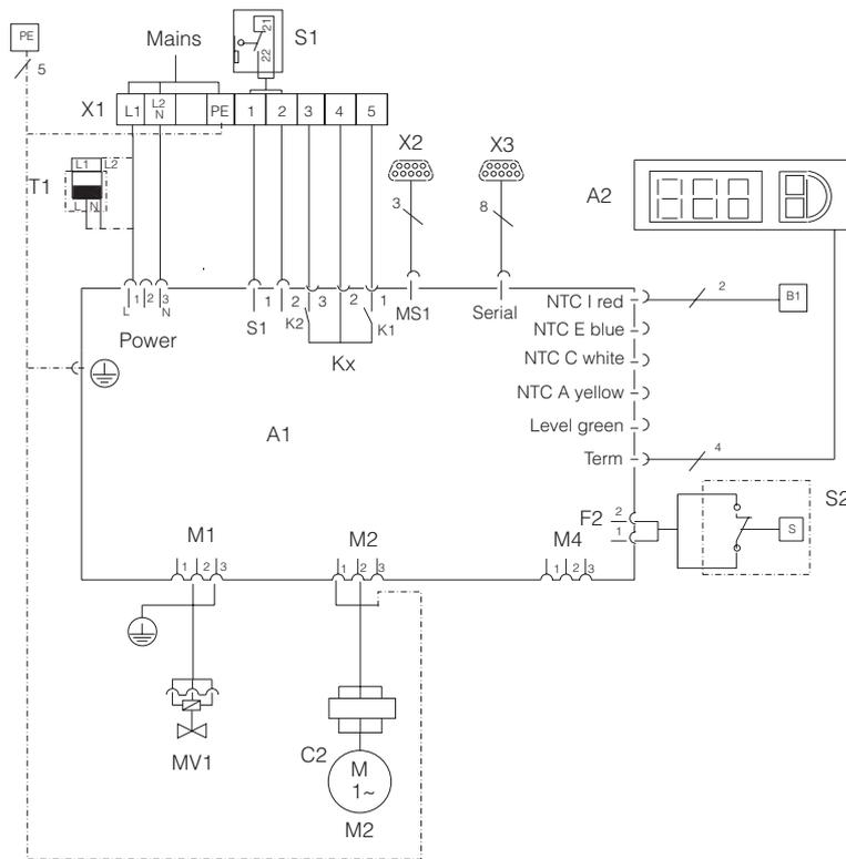
Imagen 15: Esquema de conexiones electrónicas n° 2
