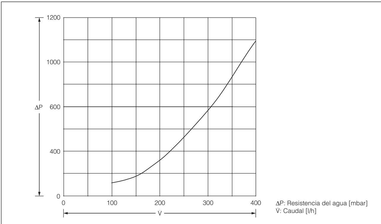
Imagen 35: Resistencia del agua SK 3210.xx0
