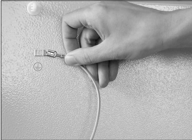
Imagen 26: Desconectar el cable de puesta a tierra
