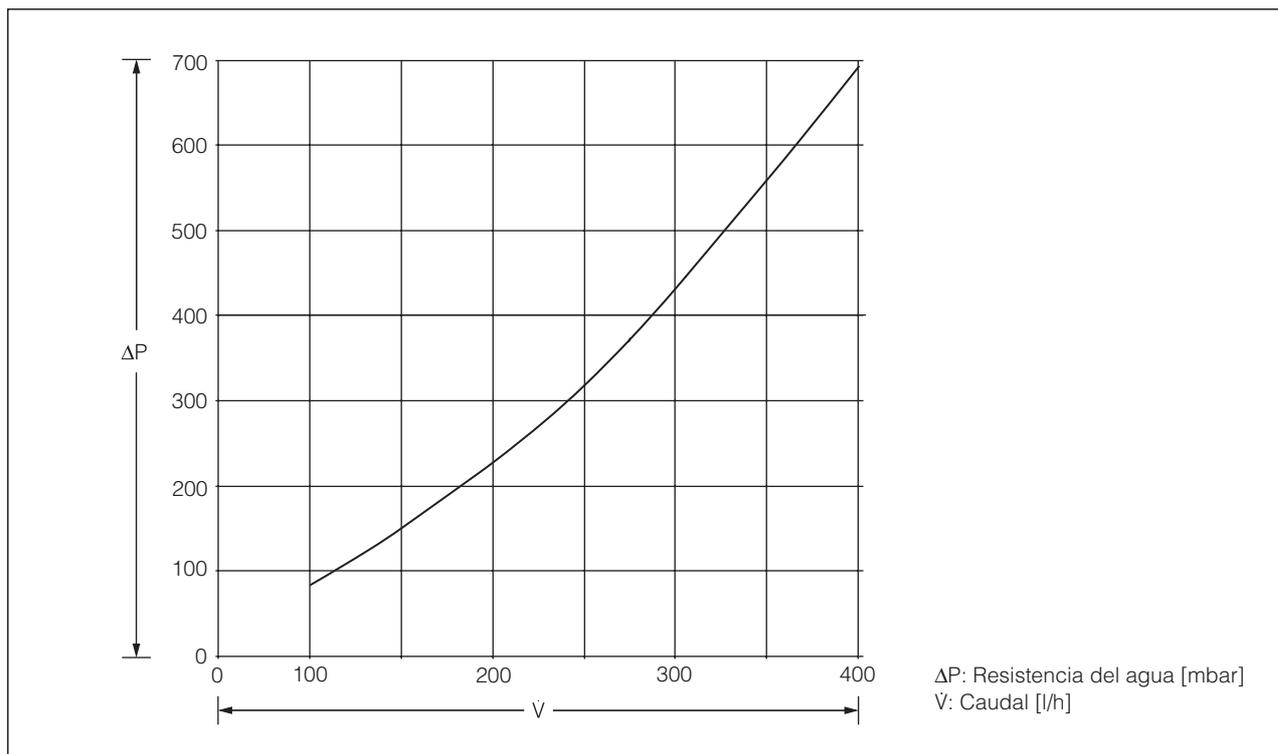
Imagen 33: Resistencia del agua SK 3209.100
