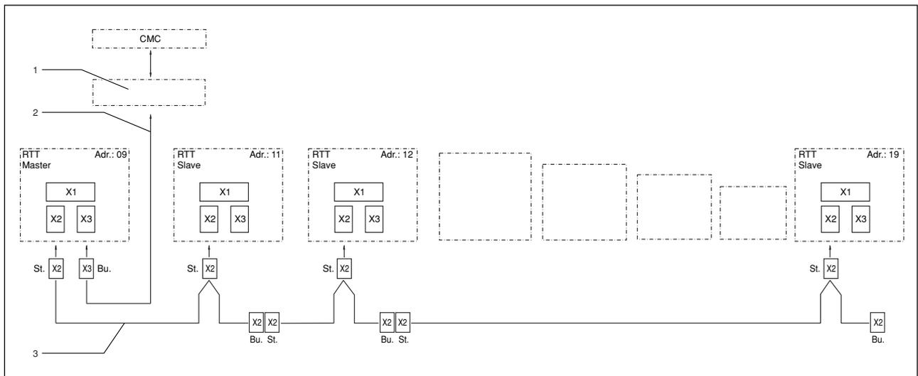
Imagen 12: Ejemplo de conexión: Funcionamiento maestro-esclavo
