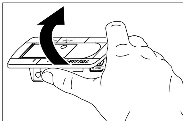
Imagen 18: Extraiga la pantalla del controlador básico
