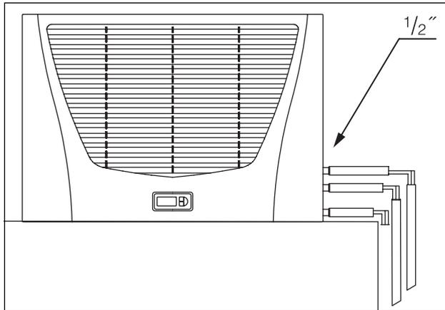
Imagen 11: Montar el tubo de agua de refrigeración
