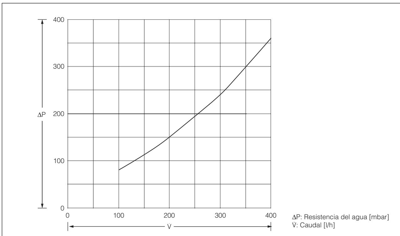
Imagen 34: Resistencia del agua SK 3209.104
