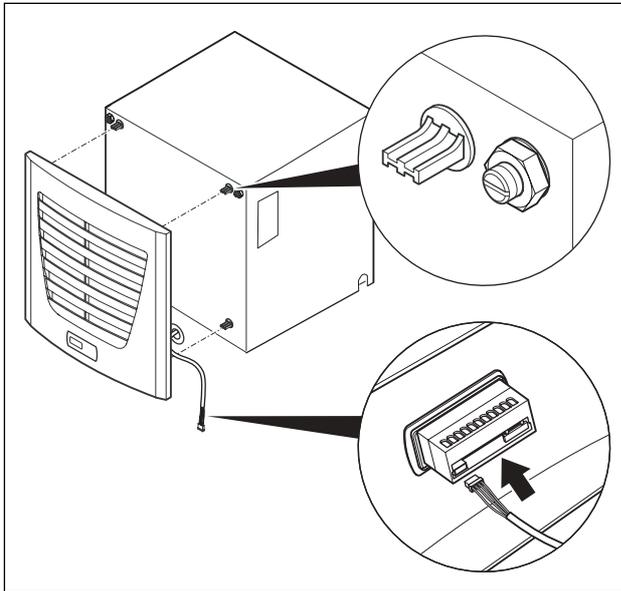
Imagen 16: Colocar la rejilla y conectar el display
