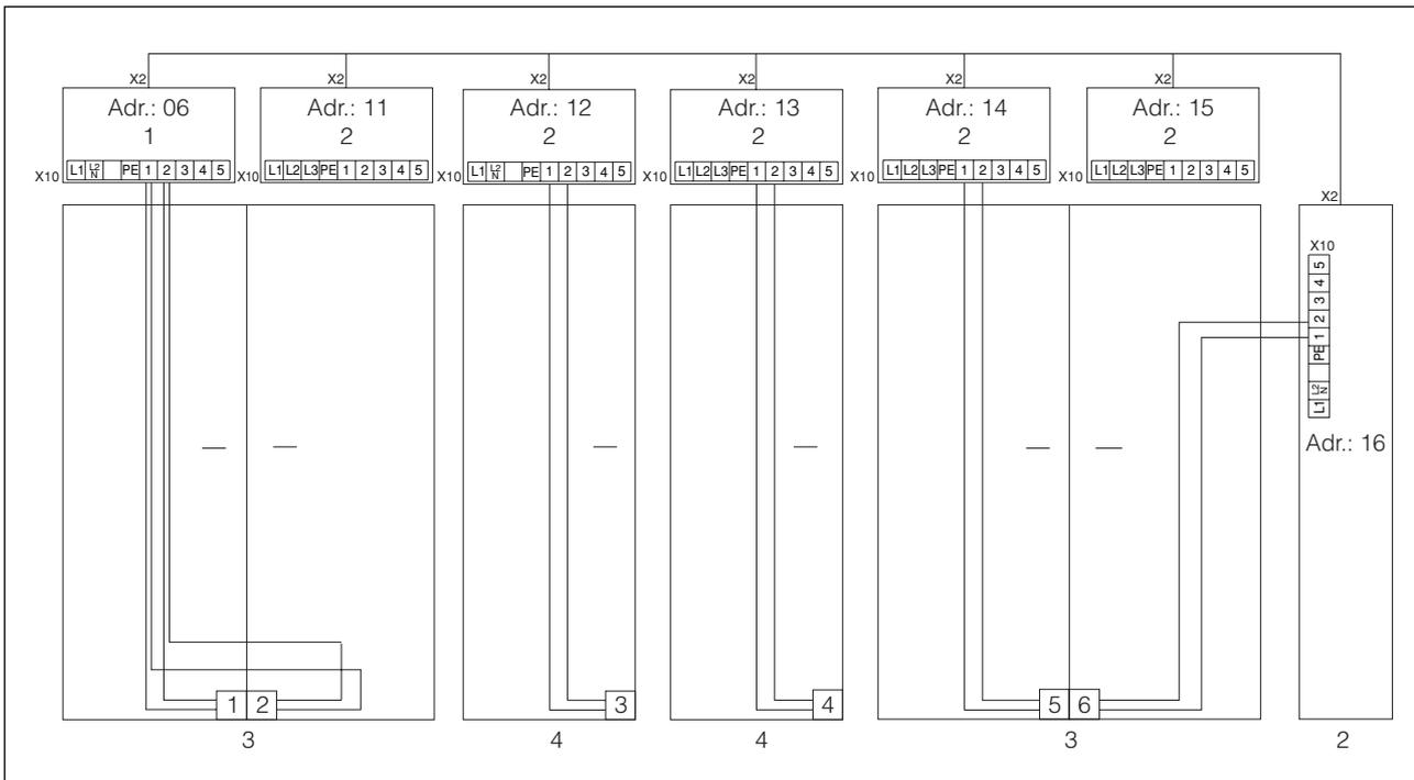
Imagen 13: Ejemplo de conexión: Interruptor final de puerta y funcionamiento maestro-esclavo
