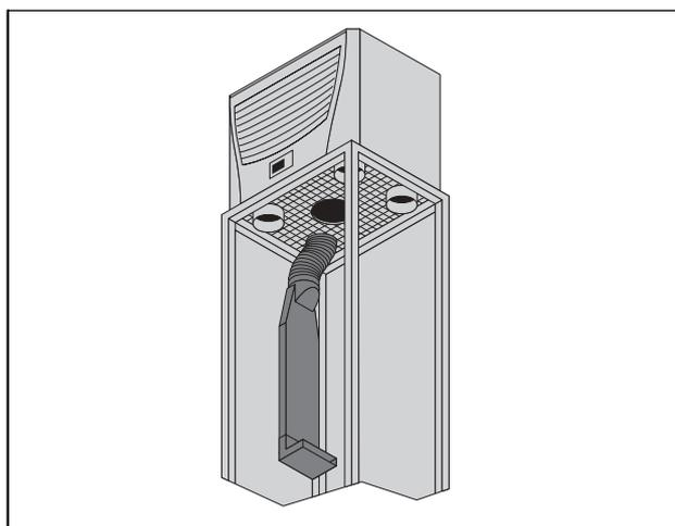
Imagen 4: Guiado efectivo del aire en el armario
