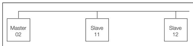
Imagen 21: Cableado maestro-esclavo (ejemplo)
