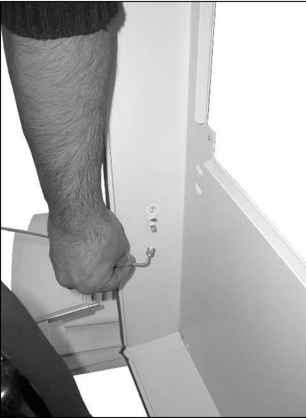
Imagen 77: Desconectar el cable de puesta a tierra (2)
