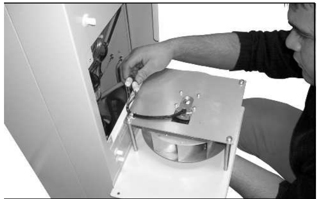
Imagen 69: Desconectar el ventilador (1)
