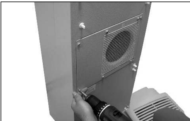
Imagen 67: Extraer los cuatro tornillos del ventilador del circuito exterior
