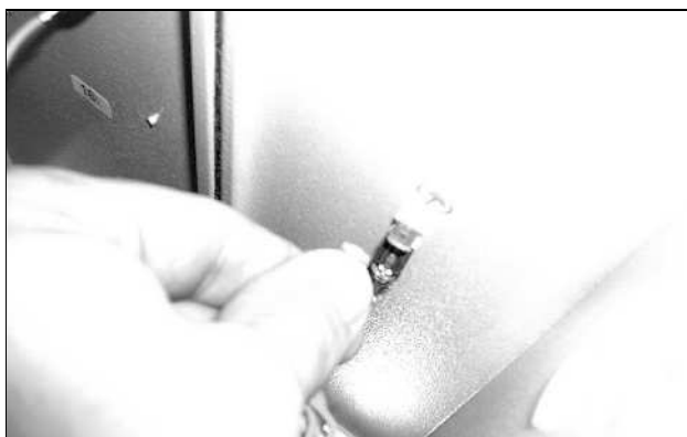
Imagen 73: Desconectar el cable de puesta a tierra del ventilador (2)
