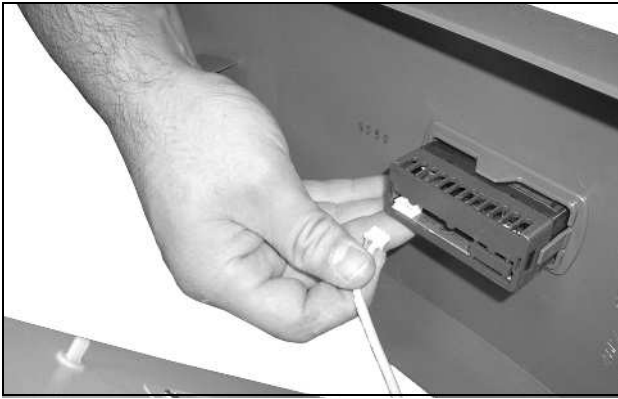
Imagen 64: Desconectar el cable del display
