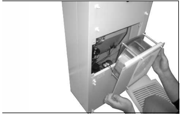
Imagen 68: Desmontar el ventilador del circuito exterior
