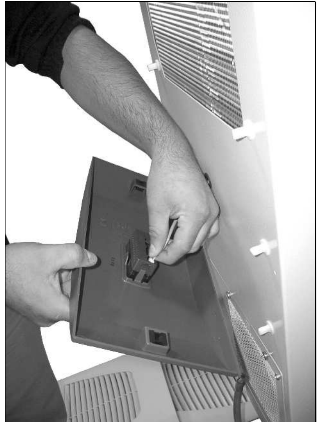
Imagen 42: Desconectar el display (1)
