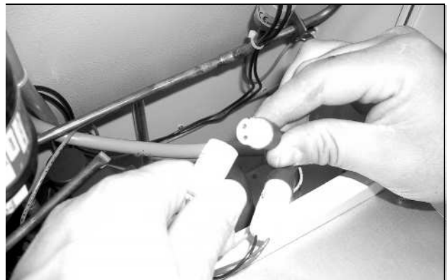
Imagen 71: Desconectar el ventilador (3)
