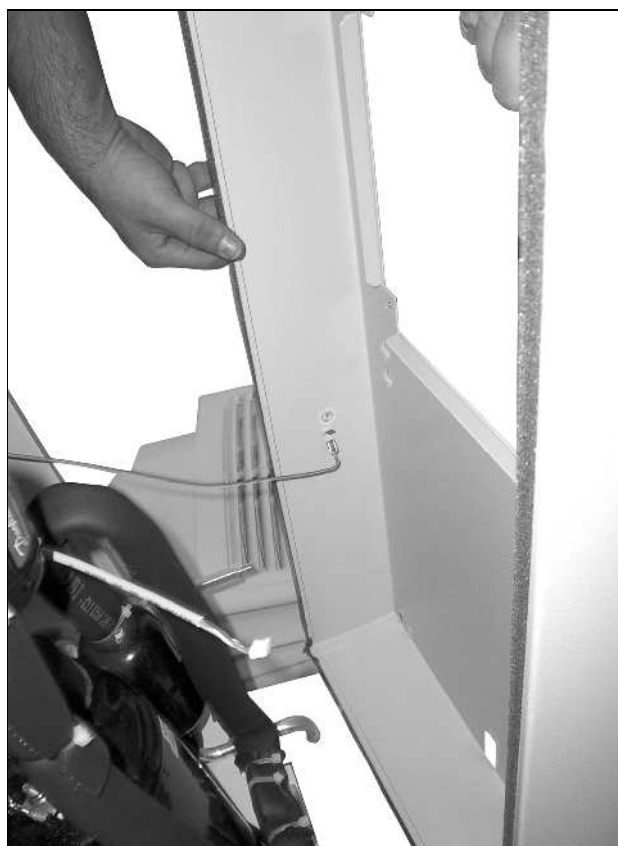
Imagen 76: Desconectar el cable de puesta a tierra (1)
