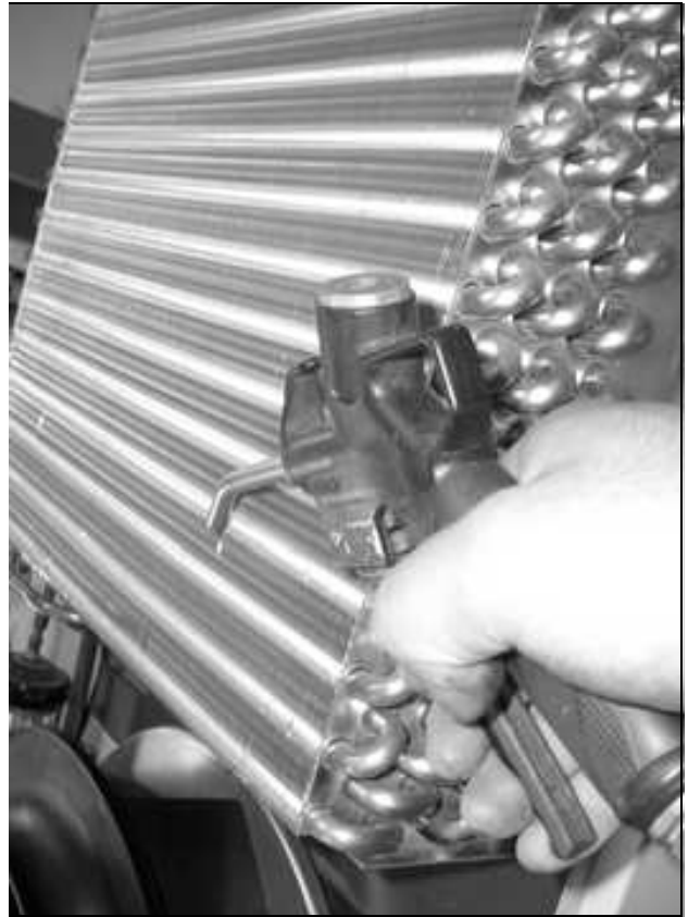
Imagen 79: Aplicar aire a presión en el registro del intercambiador de calor y el espacio del compresor (2)
