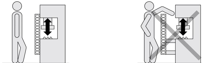
Figura 8: Representación a modo de ejemplo de la posibilidad de acceso por arriba en el DPSC. Izquierda: campo de protección sin posibilidad de acceso por arriba. Derecha: campo de protección con posibilidad de acceso por arriba.
