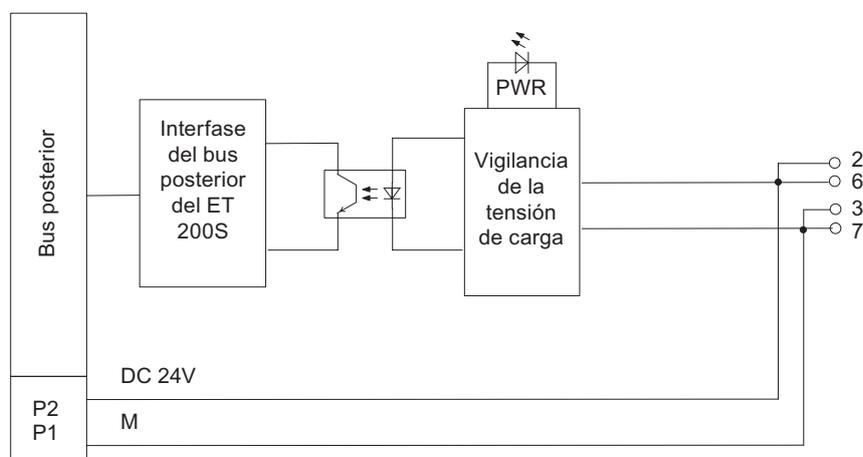
Figura 1-1 Esquema de principio del módulo de potencia PM-E DC24..48V
