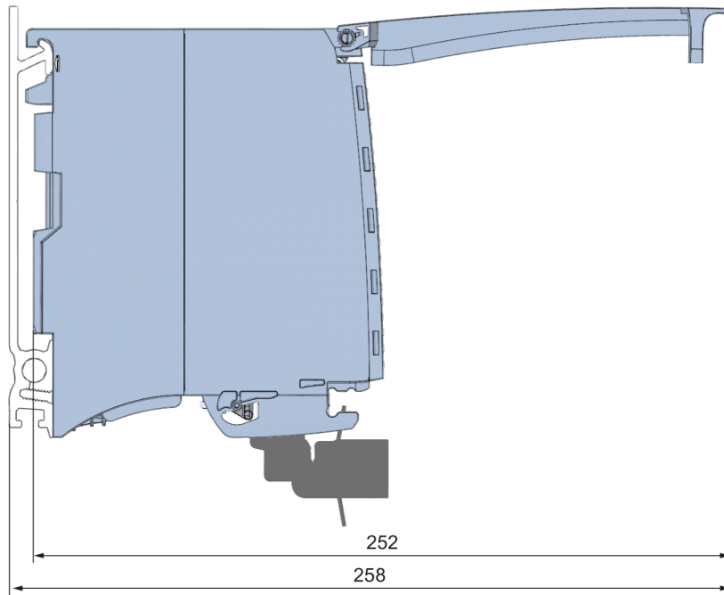
Figura A-2 Croquis acotado del módulo AI 8xU//RTD/TC ST, vista lateral con tapa frontal abierta
