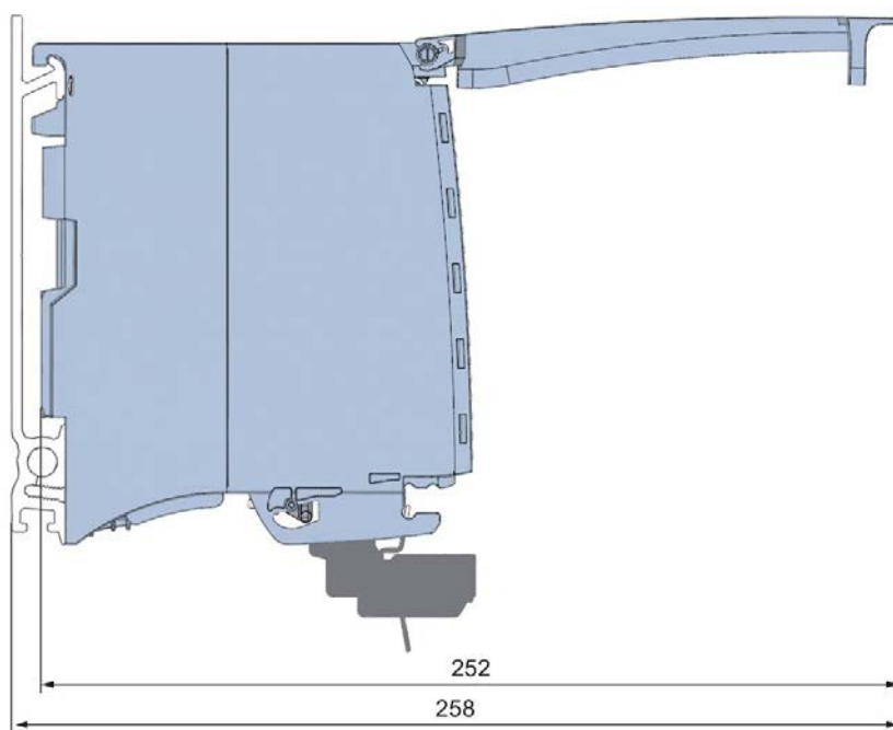
Figura A-2 Croquis acotado del módulo TM Count 2x24V, vista lateral con tapa frontal abierta
