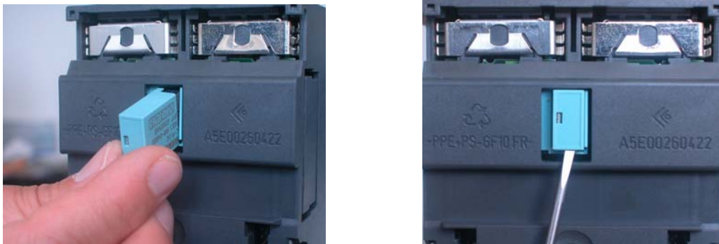
Figura 3-2 Colocar el C-PLUG en el IE/PB Link PN IO y retirar el C-PLUG del IE/PB Link PN IO con ayuda de un destornillador
