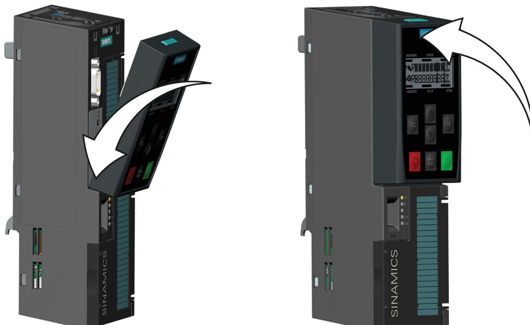
Figura 5-1 Instalación del BOP-2 en la Control Unit
