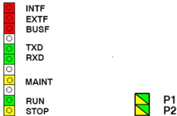
Figura 4-1 LEDs de la placa frontal del CP 443-1 (EX30)
