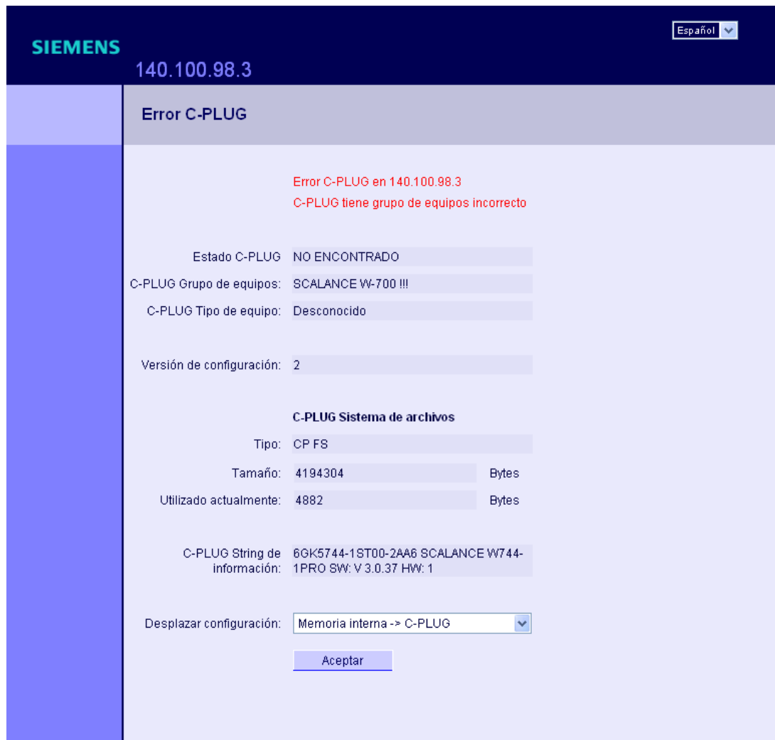
Figura 5-1 Mensaje "Error C-PLUG"
