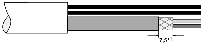
Figura 4-9 Cable PROFIBUS Hybrid con macarrón termorretráctil
