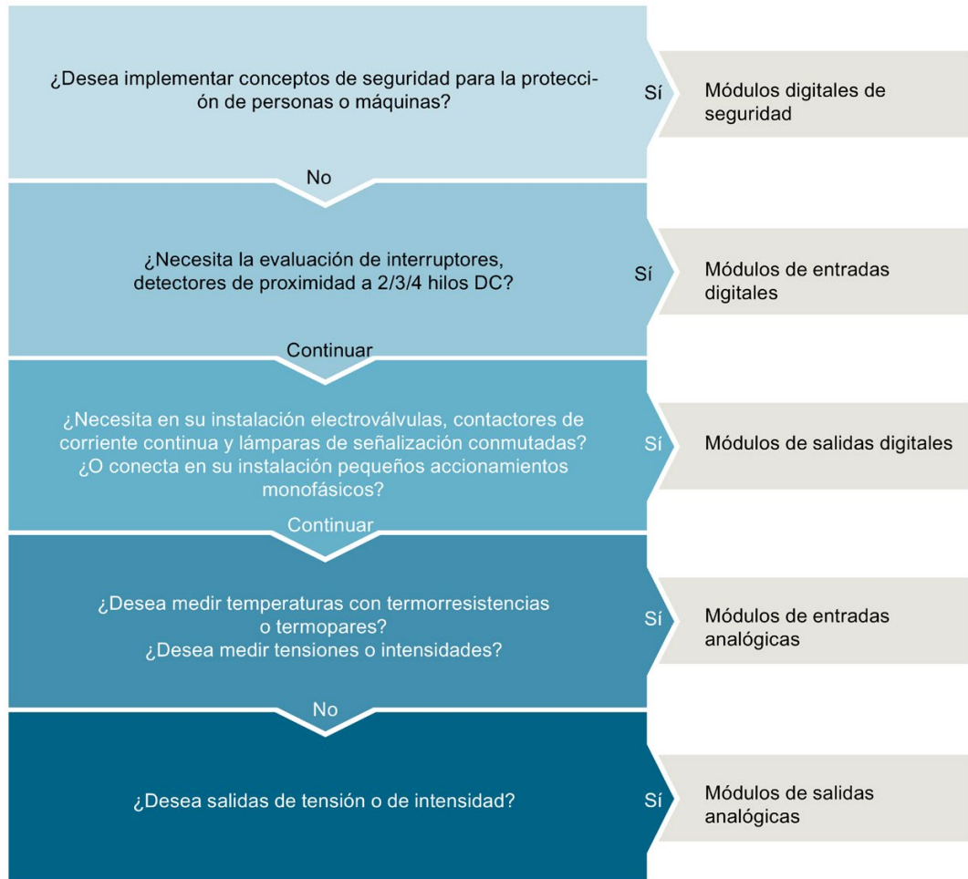
Figura 3-19 Guía de selección de módulos de entradas y salidas
