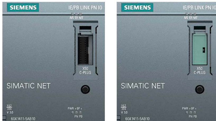
Figura 3-3 Izquierda: IE/PB-LINK PN IO sin C-PLUG / Derecha LINK con C-PLUG
