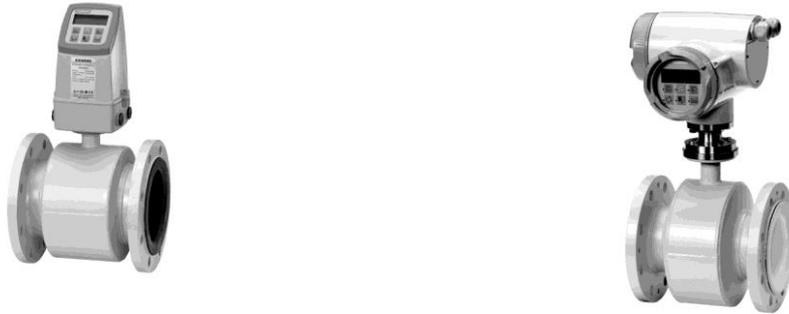
La caja y las bridas de sensor han sido diseñadas en acero al carbono (ASTM A 105) y la caja de bornes está construida en poliamida reforzada con fibra de vidrio u, opcionalmente, en acero inoxidable (AISI 316). La tubería de medida está fabricada en acero inoxidable (AISI 304), mientras que los revestimientos y electrodos están disponibles en diferentes materiales, lo que otorga al sensor una gran resistencia frente a una amplia variedad de sustancias químicas.
