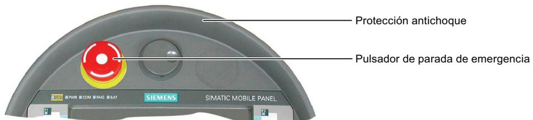
El pulsador de parada de emergencia es un componente expuesto debido a su altura de construcción. Un revestimiento en forma de collarín funciona como protección contra caída. De ese modo, el pulsador no perderá su funcionalidad aunque el Mobile Panel 277F IWLAN sufra una caída. El pulsador de parada de emergencia está bien protegido contra cualquier posible daño.
