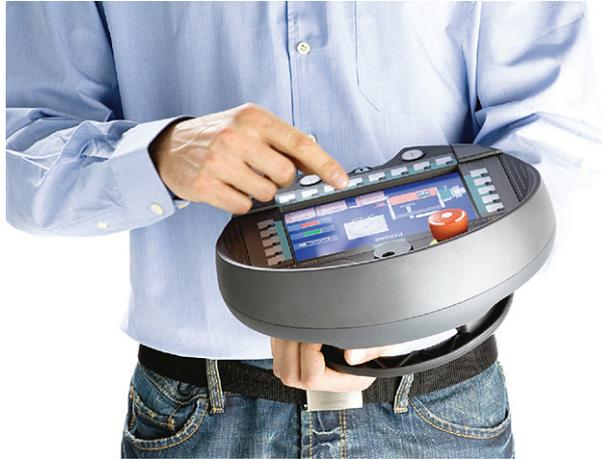
Con la mano que sostiene el panel de operador se puede accionar también la tecla de validación. La tecla de validación queda accesible de forma óptima. En una situación de peligro, al soltar o pulsar la tecla de validación se activa una desconexión en caso de posibles reacciones de pánico.
