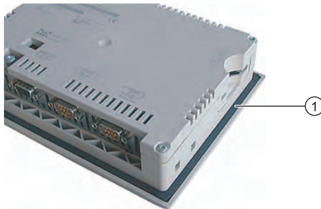
① Junta de montaje
