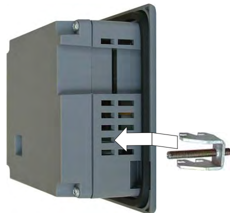
Ejemplo: Colocación de una mordaza de fijación metálica en el TP 177A 4"
