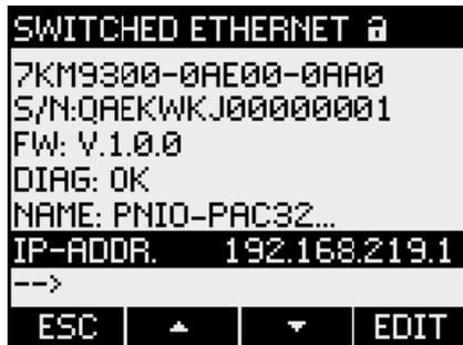
Imagen 6-3 Módulo SENTRON SWITCHED ETHERNET PROFINET: Información en SENTRON PAC
