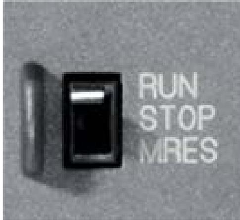
Figura 5-3 Posiciones del selector de modo
