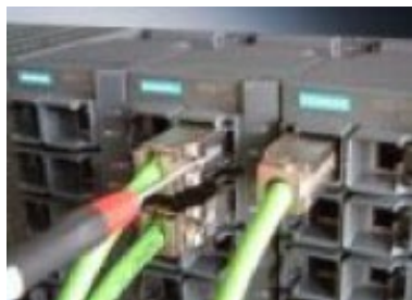
Figura A-4 Desbloqueo del RJ45 Plug con un destornillador (con el IE FC RJ45 Plug 180 a modo de ejemplo)
