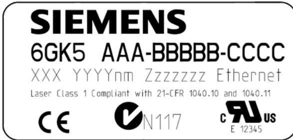
Figura 9-8 Modelo de placa de características de SFP, arriba
