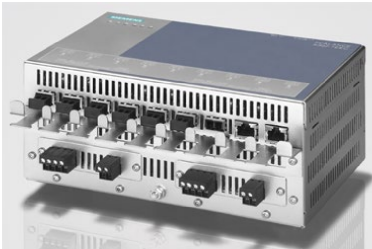
Figura 4-17 SCALANCE X302-7EEC (desde abajo) con asa protectora y conector de LC
