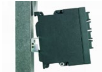
Figura 5-2 Desmontaje de un IE Switch X-300 de un riel de perfil de sombrero DIN (35 mm)
