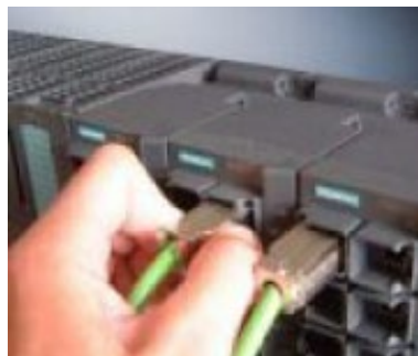
Figura A-3 Desbloqueo del RJ45 Plug (con el IE FC RJ45 Plug 180 a modo de ejemplo)
