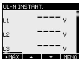
Imagen 3-2 Visualización de la tensión medida para el tipo de conexión 3P3W
