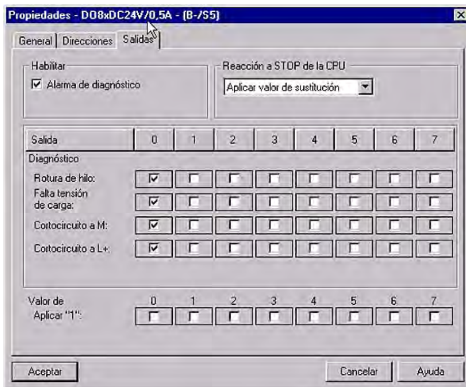
Figura 2-5 En el cuadro de diálogo de propiedades del esclavo DP para SM 322
