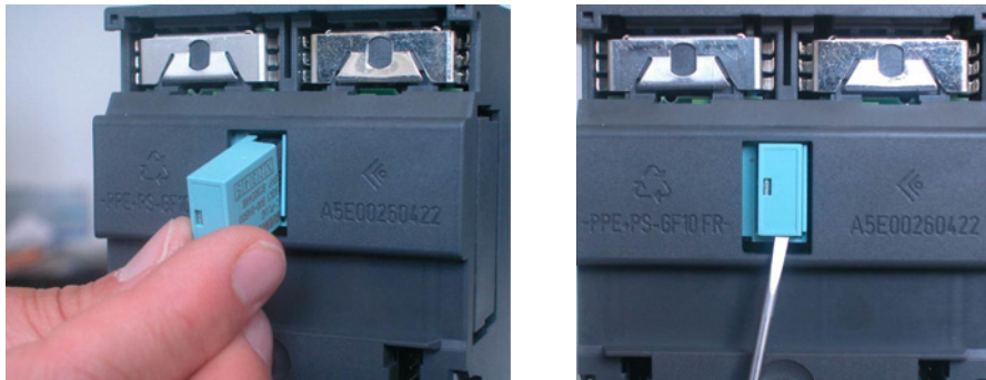
Inserción del C-PLUG (lado izquierdo) y extracción del CP con ayuda de un destornillador (lado derecho)
