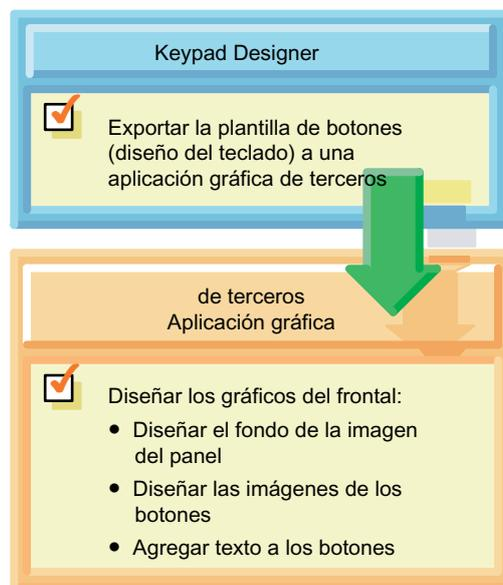
Figura 3-12 Crear la imagen del panel: exportar el diseño de los botones
