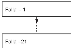
Imagen 2-29 Memoria de fallas, módulo de mando con display
