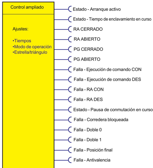
Imagen 5-9 Bloque de función "Control ampliado"
