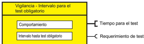
Imagen 6-12 Bloque de función "Vigilancia - Intervalo hasta test obligatorio"
