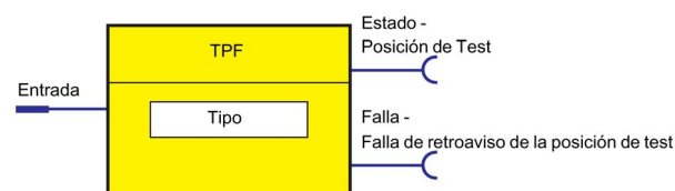
Imagen 10-3 Bloque de función "Retroaviso de la posición de test"
