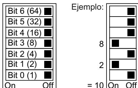
Figura 4-34 Interruptor de direcciones con ejemplo para la dirección de bus 10
