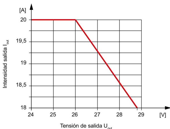
Figura 8-29 Derating de intensidad para temperaturas ambiente > 40 °C en función de la tensión de salida
