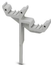
Schildchenträger, einrastbar in die Doppelstock-Zugfederklemme STTB 2,5, STTB 4, PTTB 2,5, PTTB 4, beschriftbar mit UC-TM 5, UC-TMF 5, UCT-TM 5, UCT-TMF 5, ZB 5 oder ZBF 5, grau, unbeschriftet, Montageart: stecken, Schriftfeldgröße: 5 x 10,5 mm
